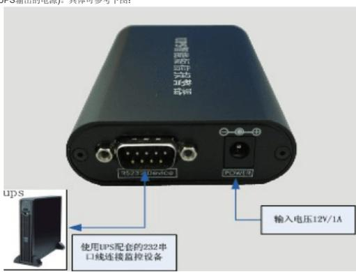
模块Device接口定义为 2--RX 3--TX 5--GND
