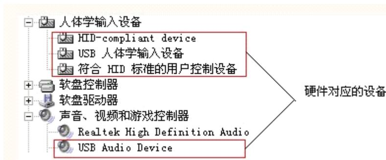
在设备连接后，实际上是原先电脑默认声卡被 USB 声卡替换，windows 是将最后一个声卡硬件插上，作为默认声卡的，USB 盒可以看作 USB 声卡设备。Windows XP 和它的以下版本，运行应用程序（不需要单独调用接口函数）会自动修改默认声卡设备改为原先的声卡。但也会出现修改不成功，比如防火墙挡住，这需要手动修改的。Windows Vista 和 Win 7 也只能手动修改。
